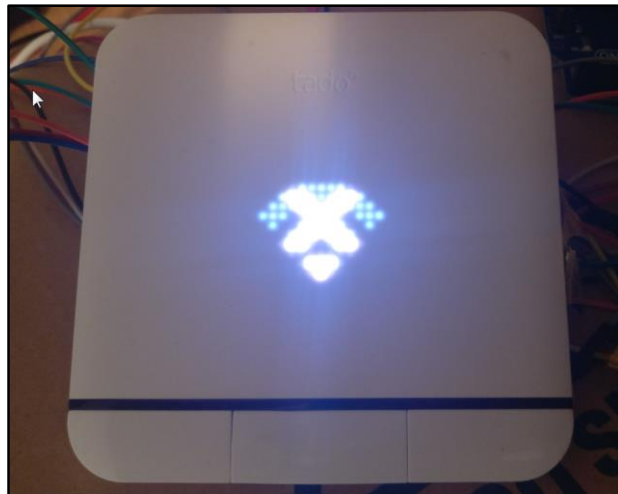
FIGURA 19 - CLIMATIZADOR TADO MOSTRANDO ERROR EN WI-FI
