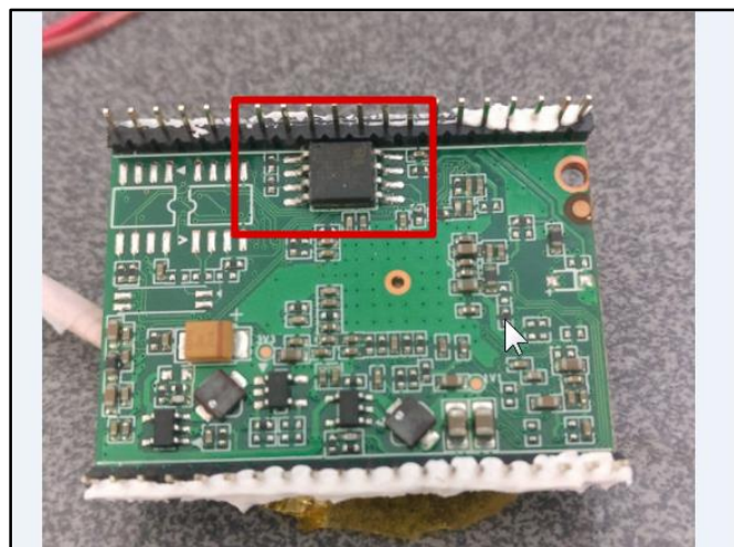
FIGURA 72 - MEMORIA FLASH DEL CIRCUITO
