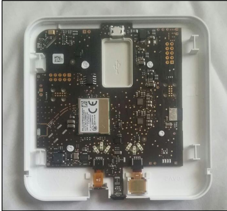
FIGURA 35 - CIRCUITO INTERNO DEL CLIMATIZADOR
